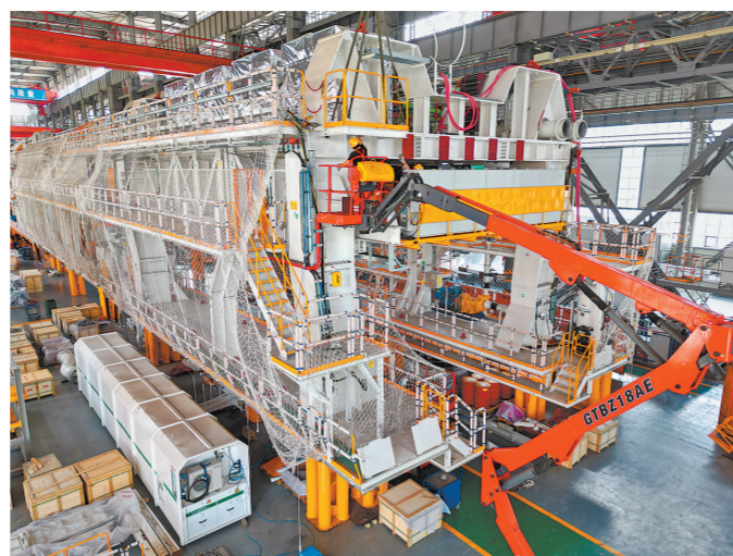
6月4日,中铁装备盾构车间内,“中铁1459号”盾构机正在拆机。
