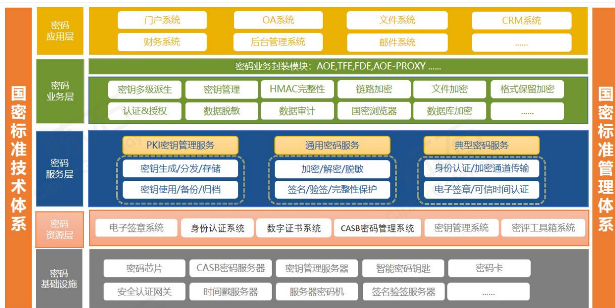
图 102 国密改造整体密码应用技术框架
