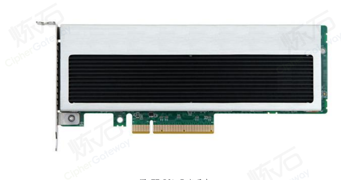
图 77 PCI-E 密码卡
