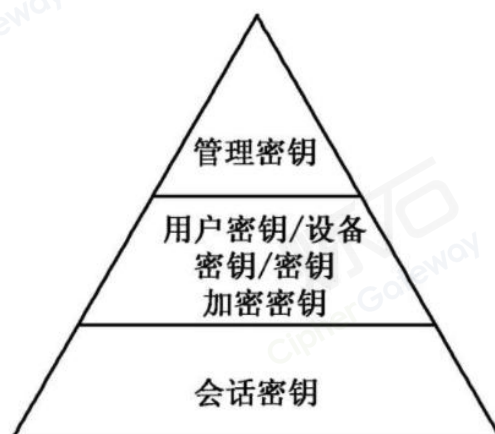
图 80 服务器密码机密钥体系结构
